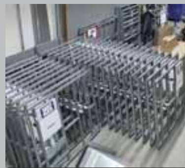
Vorgefertigte Installationswände für das Sanitär-, Heizungs- und Lüftungsgewerk.
