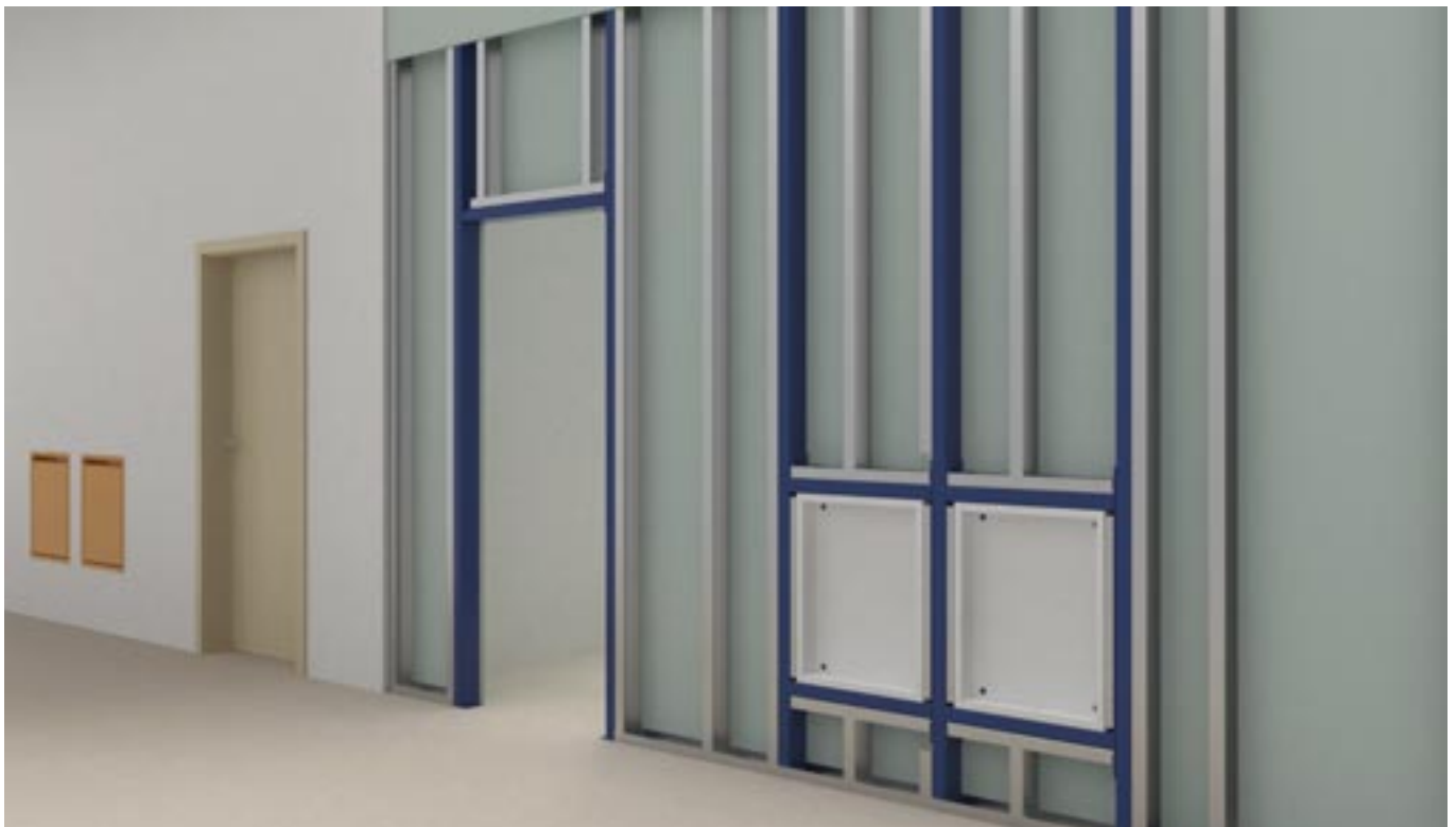
Beispiel für Wandkonstruktion mit 2 SPS-Klappsitzen KS-IW.
