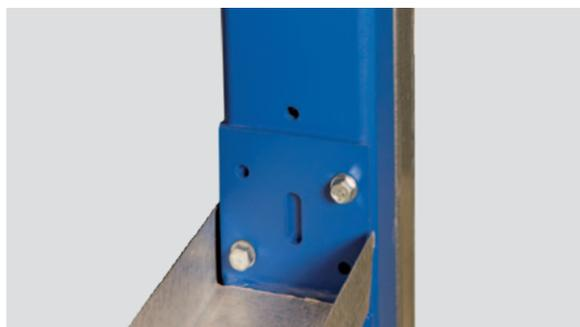
Der Sturz ist in der jeweils geforderten Höhe beidseitig mit den beiden vertikalen Stützen oder direkt am Baukörper zu befestigen. Für die Befestigung an den SPS-Stützen sind spezielle Selbstbohrschrauben mitgeliefert. Für die Befestigung direkt am Baukörper verweisen wir auf die Beschreibung der Befestigung der Stütze.
