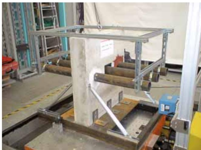
Testaufbau mit CFS-S ACR – Stahlrohr.
