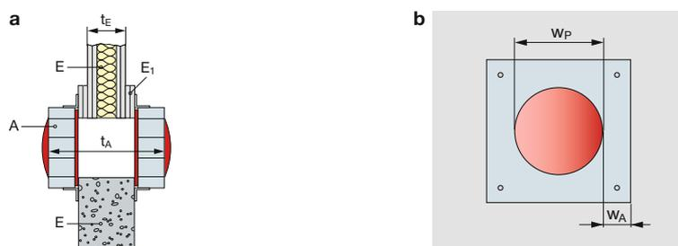
Abb. 2: Rahmung und Aufleistung der Abschottung in Wänden/Decken.
