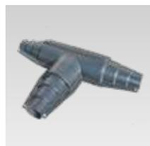
Der Isoliersatz für T-Verbindungen garantiert die vollständige Isolierung und Abdichtung von Abzweigungen. Der Doppel T-Isoliersatz wird bei Abzweigungen von single auf double Rohren eingesetzt. Die Isoliersätze bestehen aus zwei HDPE-Halbschalen, Edelstahlschrauben und einem Schmiermittel gegen das Kaltverschweißen der Schrauben.
